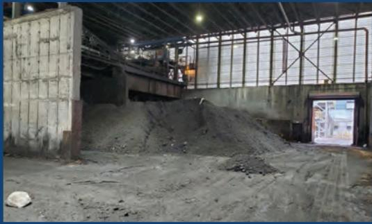
La ceniza restante se rellena o se recicla en productos útiles, como bases para carreteras, hormigón o cemento.
